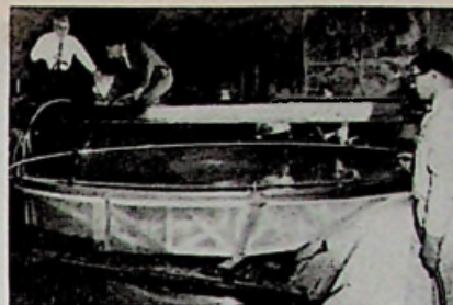
„Spincast”-antenne op de draaitafel tijdens het verguldproces. De buitengewoon nauwkeurige parabolische antenne zal worden gebruikt voor radiotelescoop-werk in het gebied van de millimetergolven.
